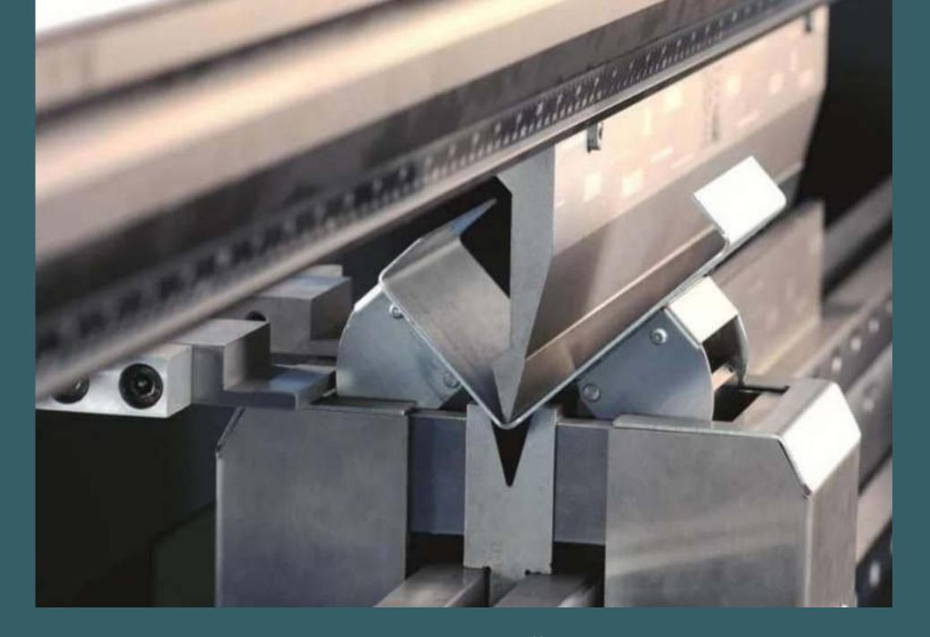
Деформация металла толщиной до 4 мм
