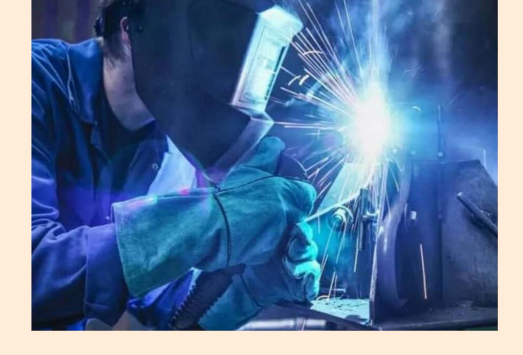
Полуавтоматическая сварка MIG/MAG сварка Аргонодуговая сварка - дуговая сварка в среде инертного газа аргона неплавящимся электродом
